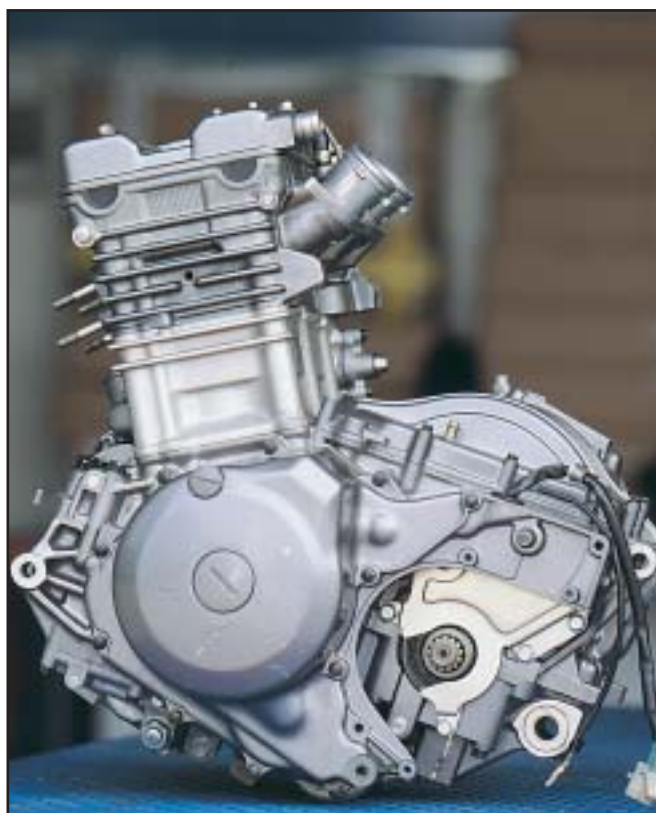
Da questa inquadratura è chiaramente visibile la notevole inclinazione dei condotti di aspirazione.
